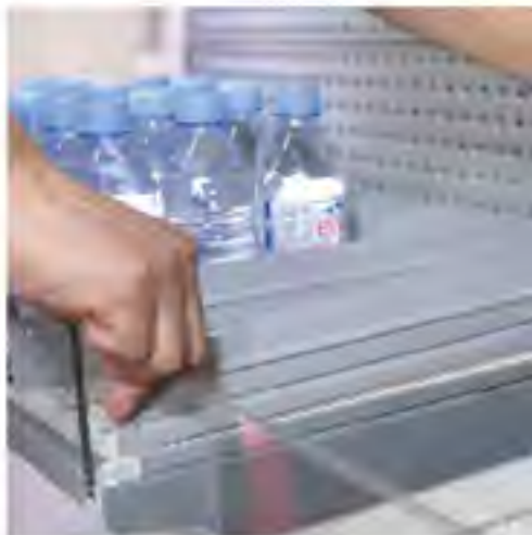
1. Instalamos nuestros divisores sobre las bandejas de estantes
